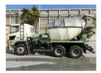
評でしたが、段々と愛着がわいてきて 今ではこれが当社のシンボルとなって おります。機能性については、真夏の 炎天下で経時 120 分までのコンクリート温度上昇量を装着無しと比較すると セメントの種類にもよりますが 3~4℃ 程度は差があることが実証されていま す。さらに、洗浄用の水タンクからドラ ムに散水できる機能もあり、気化熱の 効果で温度上昇を抑制することも可能 です。
